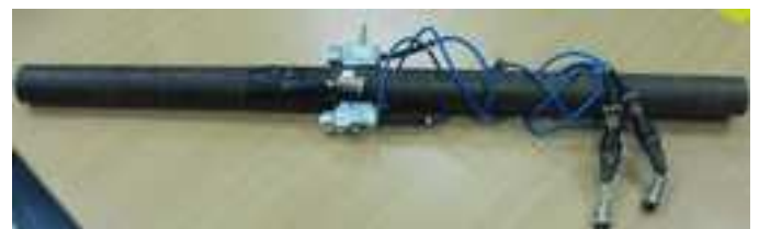
รูปที่ 5 เครื่องมือวัดพลังงานการทดสอบ SPT การสอบเทียบ load cell ทำโดยใช้เครื่อง Universal Testing Machine (UTM) กดและดึงก้านเจาะพร้อมทั้งวัดโวลต์ที่เปลี่ยนแปลงไปตามแรงที่เพิ่มขึ้น-ลดลง จำนวน 3 รอบการ
