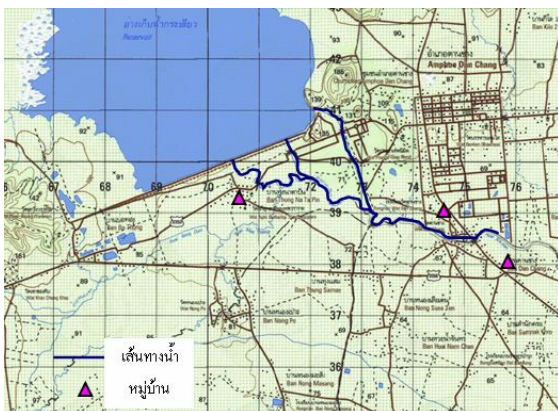
ภาพที่ 2 แผนที่ภูมิประเทศของพื้นที่ท้ายน้ำ แสดงการวิเคราะห์ระยะทางที่น้ำเดินทางถึงหมู่บ้านและแนวทางการหาจำนวนประชากรที่ได้รับผลกระทบ
