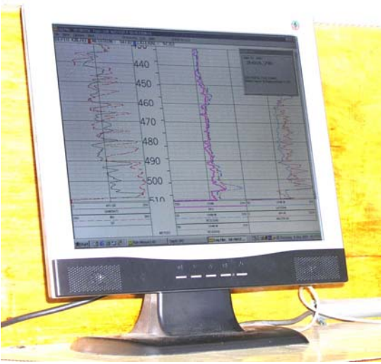
ภาพที่ 1 ตัวอย่างผลการตรวจวัดในสนามด้วยเทคนิค Wire line logging
