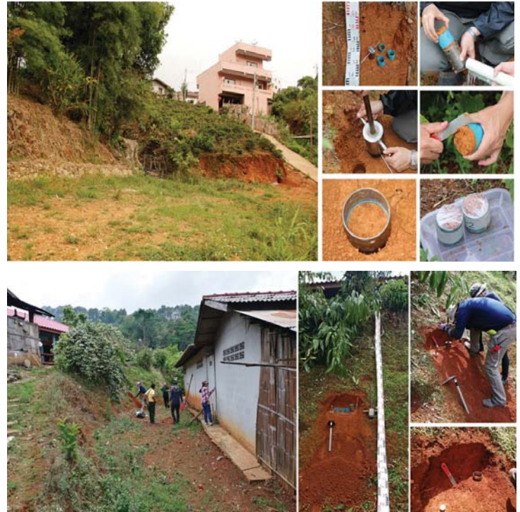
รูปที่ 7 ชุดอุปกรณ์เก็บตัวอย่างดินคงสภาพระดับตื้น (KU-Miniature Sampler) (ล่าง) การเก็บตัวอย่างดินแบบคงสภาพ (Undisturbed soil sampling) ในพื้นที่บ้านสันติคีรีและบ้านธาตุ
