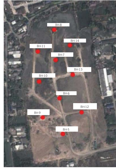
รูปที่ 4 ตำแหน่งหลุมเจาะสำรวจก่อนปรับปรุงคุณภาพดิน
