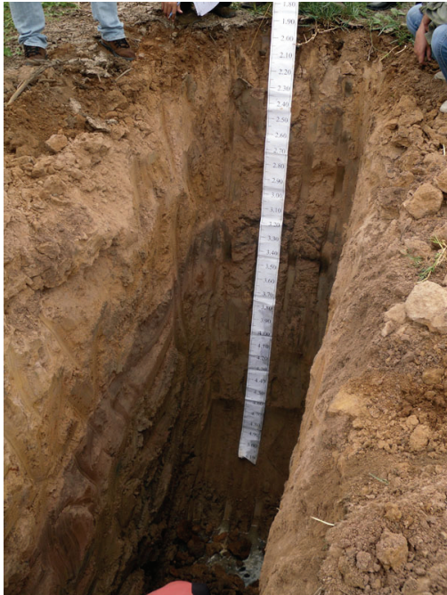
รูปที่ 3 การขุดหลุมสำรวจ (Test Pit)
