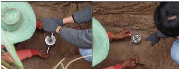
รูปที่ 4 เก็บตัวอย่างดินแบบคงสภาพ
