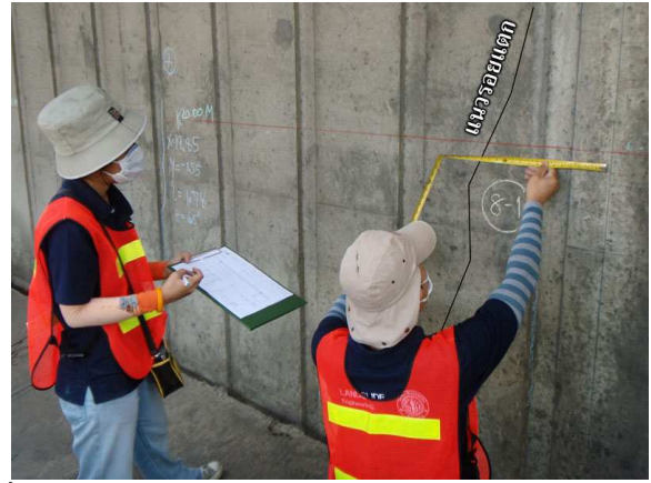
ภาพที่ 4 การวัดมุมเอียง และความยาวของรอยแตกร้าวในสนาม
