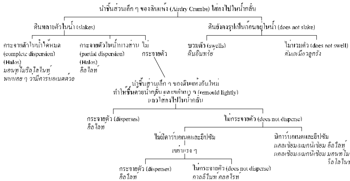
รูปที่ 3 แผนภูมิจำแนกดินกระจายตัว โดยวิธี Emerson Crumb Test [3]
