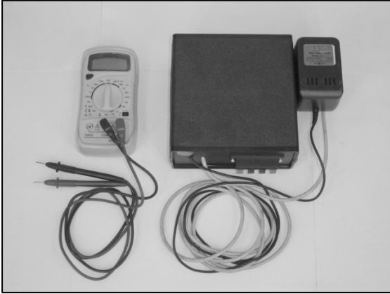
รูปที่ 6 ชุดในการจ่ายไฟเลี้ยงและอ่านค่า Output Signal
