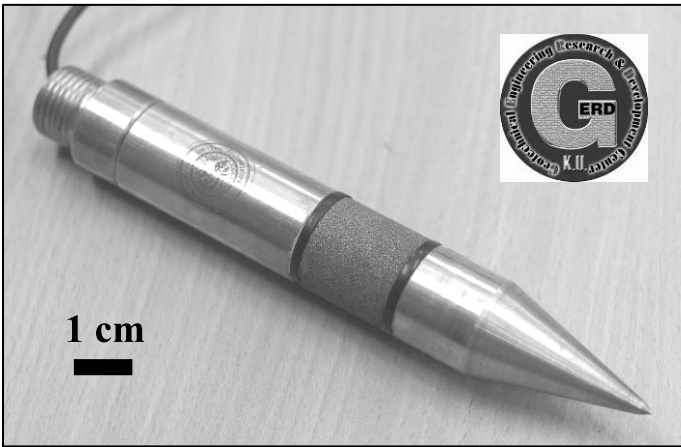
รูปที่ 3 ลักษณะภายนอกของ KU - Piezometer
