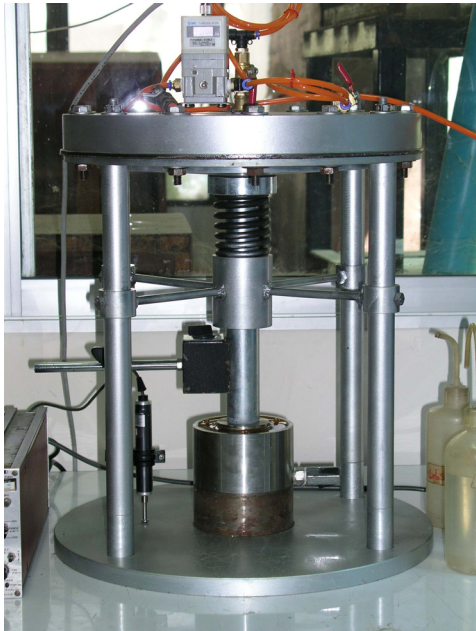
รูปที่ 2 เครื่องมือทดสอบ High Pressure Consolidation
