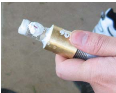
Fig. 4 KU miniature tensiometer
