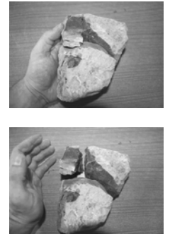
Figure 6. Gros granulats de STV récupérés après essai triaxial.
