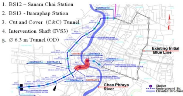
รูปที่ 1 เส้นทางการก่อสร้างโครงการรถไฟฟ้าสายสีน้ำเงินส่วนต่อขยาย
